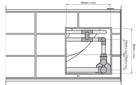
**NOTA:** El eje longitudinal del espacio entre cañerías debe coincidir con la mitad de la tapa de inspección.
